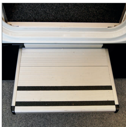
Elektrische Trittstufe mit automatischer Einfahrfunktion
